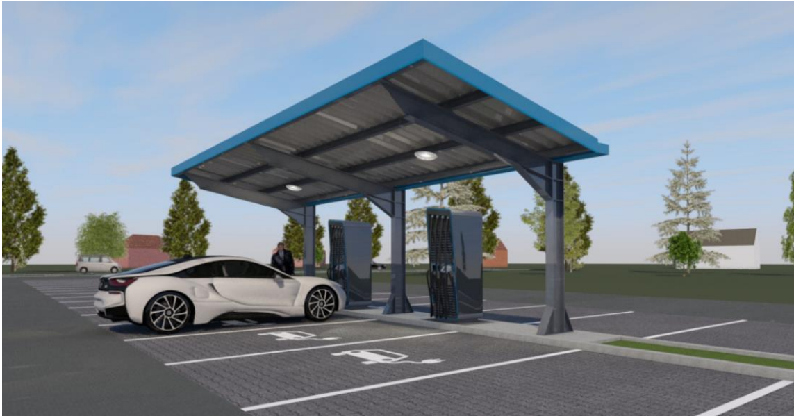
Abbildung 54: Modell E-Ladepark mit PV-Überdachung (Quelle: Siebe 2021)
